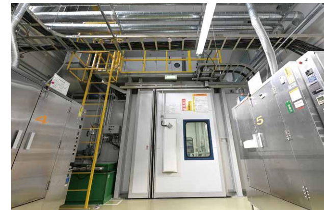
温度・湿度管理付塗装ブース Coating booth with air conditioning
