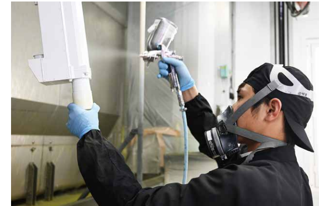
温度・湿度管理付塗装ブース Coating booth with air conditioning
