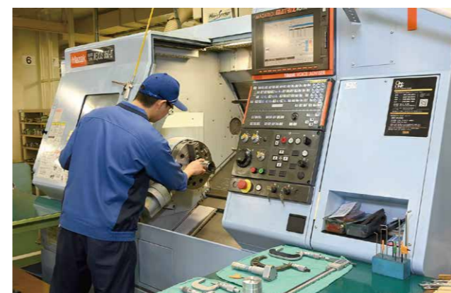
油圧チャック旋盤 Hydraulic chuck lathe
